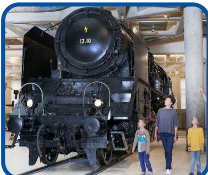
Die 12.10er-Dampflokomotive wurde in den 1930er-Jahren gebaut, zu einer Zeit als auch schon Elektroloks auf den Gleisen fuhren. An die Lok angeschlossen ist der Tender – ein Waggon, in dem Kohle und Wasser transportiert wurde.
